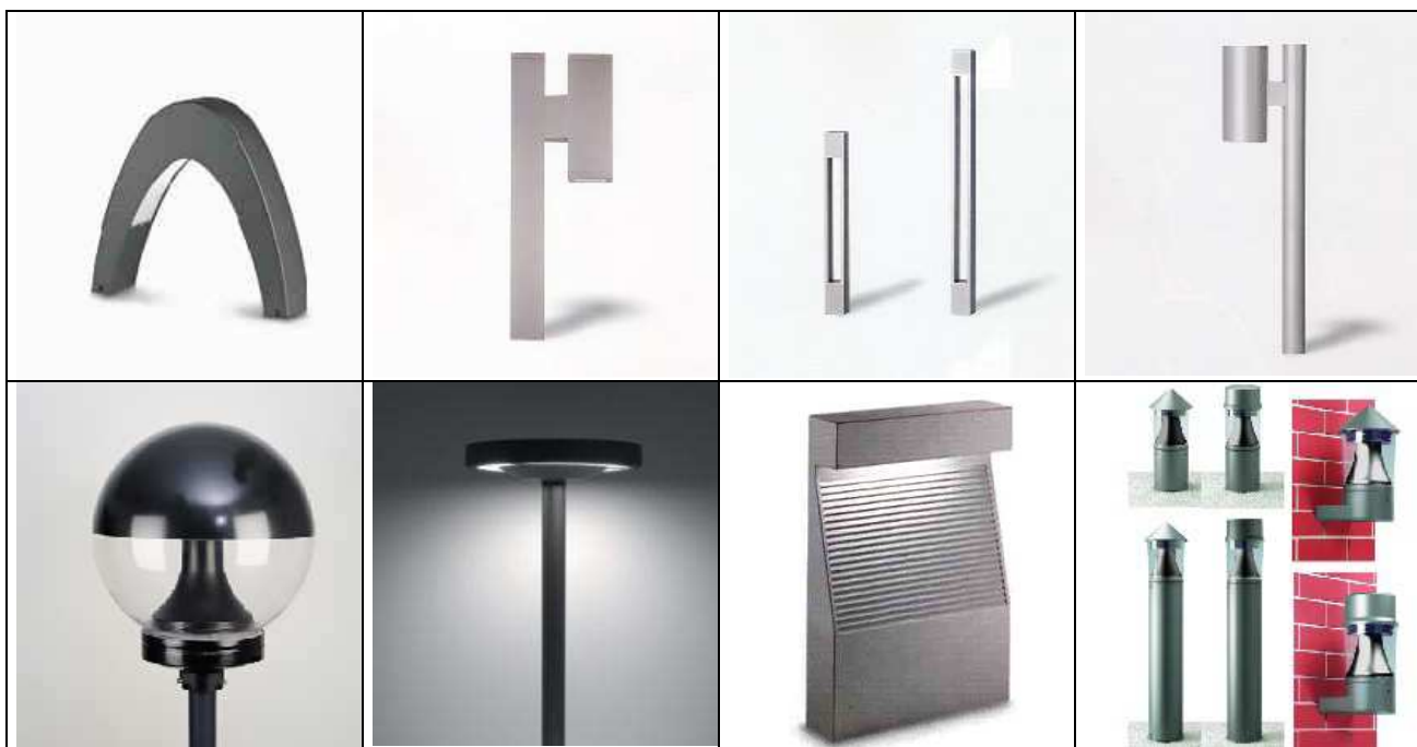
Fig. 3.184 – Apparecchi con emissione nulla verso l'alto per installazione in giardini e vialetti. Attenzione che la tipologia a sfera (a sinistra in basso) esiste in pochissimi modelli conformi alla legge regionali; tutte le altre versioni se dotate di sorgente con meno di 1500lm possono rientrare nelle deroghe di legge ma solo dopo attente verifiche.
